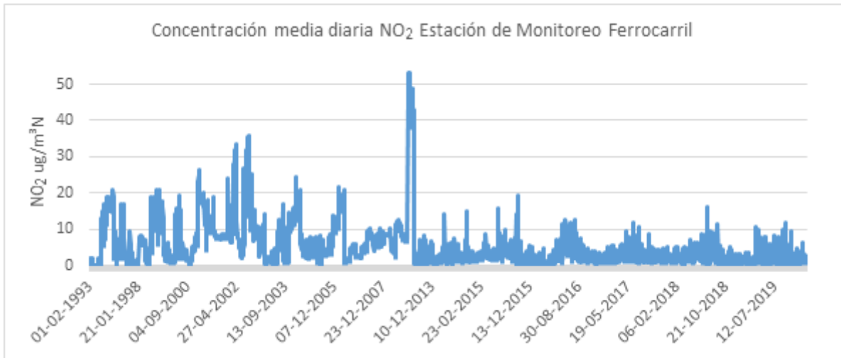
FIGURA 12. Valores de concentración media diaria de NO 2 en ug/m 3 N para la estación de monitoreo Ferrocarril medidos en la línea base del Proyecto Central Termoeléctrica Mejillones Unidad 2 del año 1993 y en los subsecuentes informes de monitoreo entregados a las autoridades dentro del marco del plan de seguimiento del proyecto. 66
