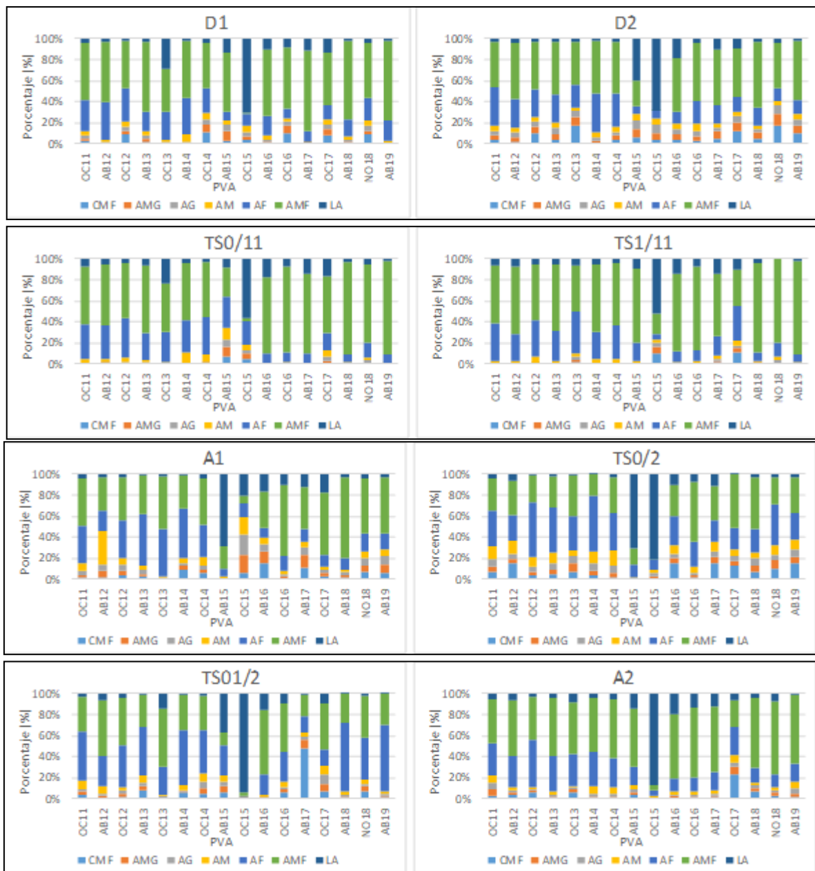
Figura 4. Composición granulométrica en las estaciones de monitoreo para el proyecto Central Térmica Andino entre octubre 2011 y abril 2019. Se muestra el porcentaje de partículas en orden decreciente de tamaño. CMF: Cascajo Muy Fino, AMG: Arena Muy Gruesa, AG: Arena Gruesa, AM: Arena Media, AF: Arena Fina, AMF: Arena Muy Fina, LA: Limo y Arcilla. Elaboración propia a partir de la información entregada en los Planes de Vigilancia Ambiental.
