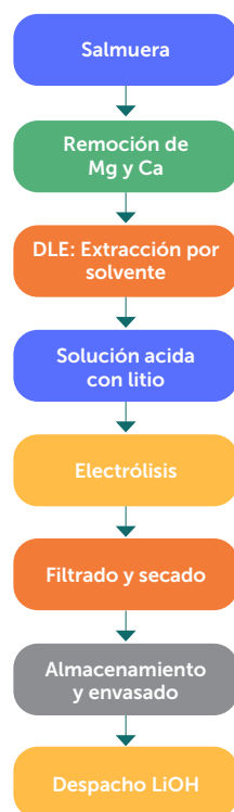
Figura 14. Esquema del proceso particular para la obtención de hidróxido de litio considerando la tecnología de extracción por solvente
